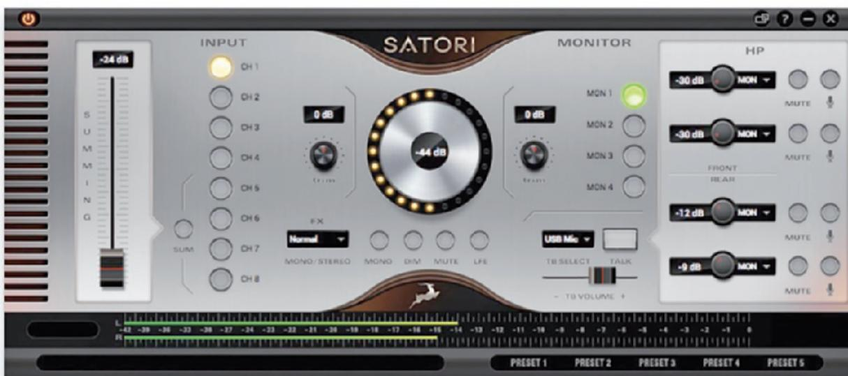
Figura 2 - Il pannello di controllo di Satori, con il fader per il livello del sommatore, la sezione delle coppie di ingressi e di monitor, e la programmazione delle cuffie
