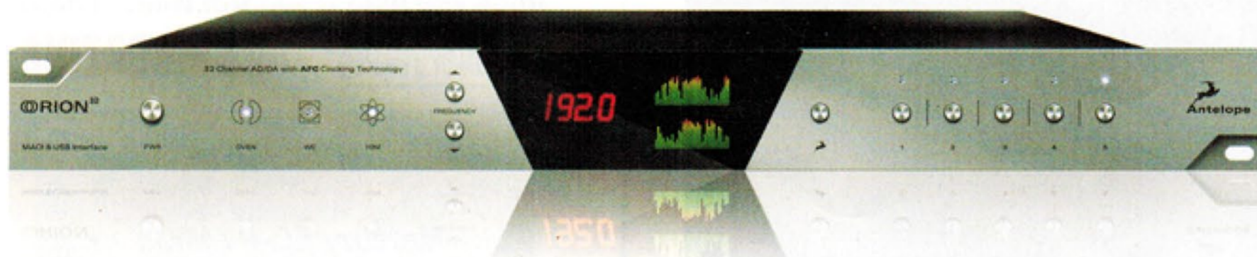
L'Orion32 d'Antelope Audio offre des entrées/sorties via USB, MADI, ADAT et S/PDIF
